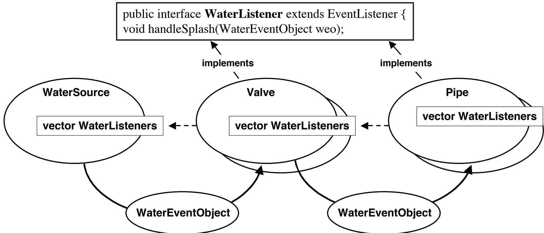
La source envoie périodiquement des événements (émission d'eau) aux valves et tuyaux. Une valve peut être fermée (elle arrête l'eau) ou ouverte (elle laisse passer, donc retransmet l'événement). Un tuyau se comporte comme une valve ouverte. Un ensemble de tuyaux et valves sont interconnectés.
