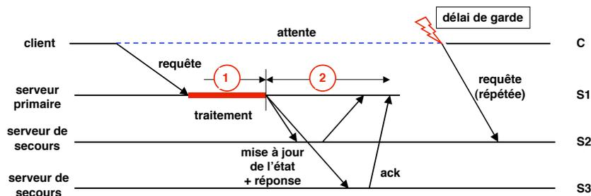
Défaillance du primaire : détectée par le client (délai de garde) et par les serveurs de secours (mécanisme de groupe, défini plus loin)
