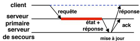
On gagne un peu de temps par rapport au schéma classique (réponse par le serveur de secours)
