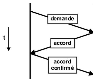
Les messages contiennent des paramètres permettant de fixer des caractéristiques de la liaison (pour la connexion)
